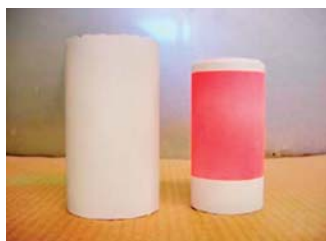
Kuva 7. Laser- ja ruiskupinnoitettu tiivisteholkki tunkeumanestetarkastuksessa.
